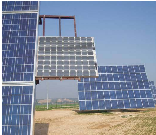
Figura 2. Detalle de los módulos calibrados utilizados para medir la irradiancia incidente y la temperatura de operación de las células. Su ubicación es coplanar con los generadores.
