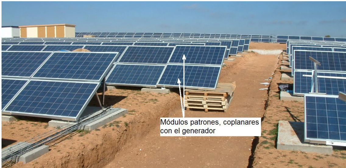
Figura 2. Módulos de referencia para la medida de la potencia CEM de los módulos individuales de un generador, en una central de 11 MW. La estructura de soporte, aunque provisional, asegura la necesaria coplanareidad. Para favorecer la rapidez, se miden los módulos ubicados en la fila superior.
